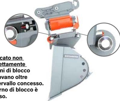
**Bloccato non correttamente.** I perni di blocco si trovano oltre l'intervallo concesso. Il perno di blocco è esteso.
