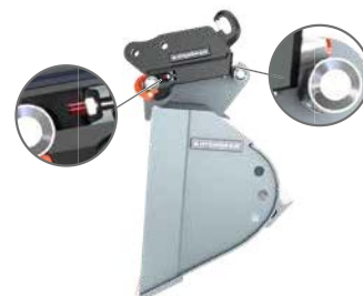
Verrouillage non correct. Les axes de verrouillage sont au-delà de la plage permise. L'axe indicateur est sorti.
